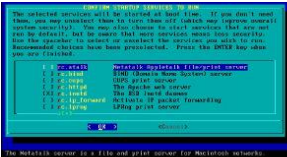
Figura 36 – Confirmação dos serviços a serem executados ao iniciar o sistema.
