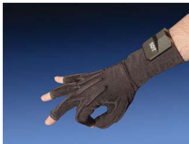
Figura 3. 5DT Data Glove 14 Ultra. Fonte: 5DT (2009).
